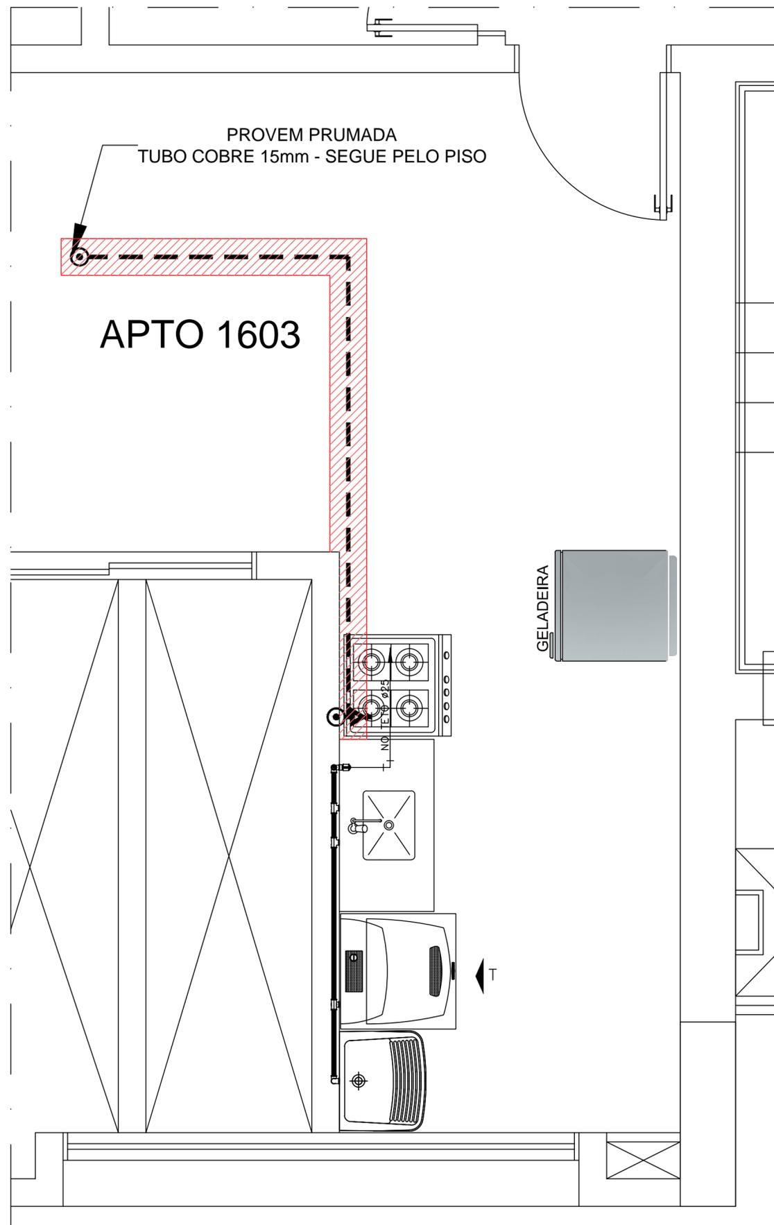
Planta Baixa da Cozinha do Apt. 1603 - Instalação Hidráulica e de Gás
